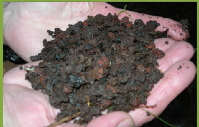
Lavasteen zorgt voor het filteren van het afvalwater.
