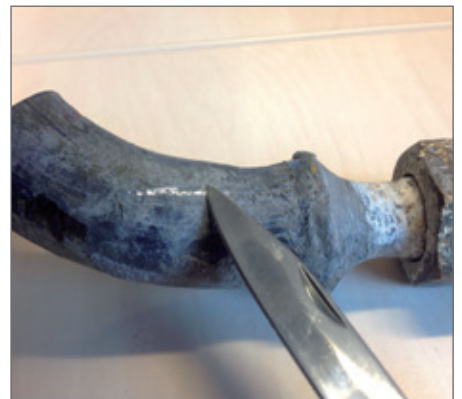
Aantikken van lood met een metalen voorwerp maakt een dof geluid.
