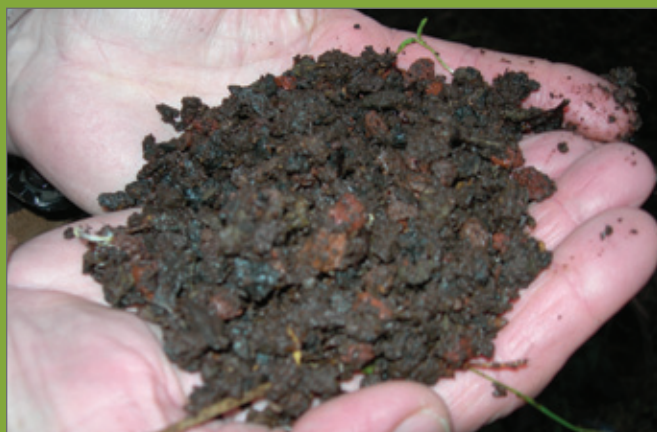
Lavasteen zorgt voor het filteren van het afvalwater.
