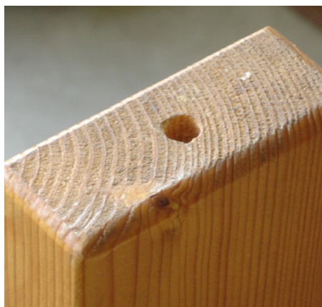
In de poten van de bedden wordt een gat voorzien voor een ijzeren staaf.
